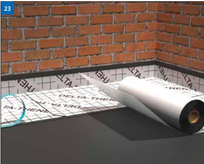
(Рис. 23) Чтобы исключить капиллярное проникновение воды через зону Т-образного (продольного) стыка, следует на покрываемом рулоне отрезать угол (примерно 10x10 см) и использовать клей DELTA®-THAN для дополнительного уплотнения Т-образного стыка.
